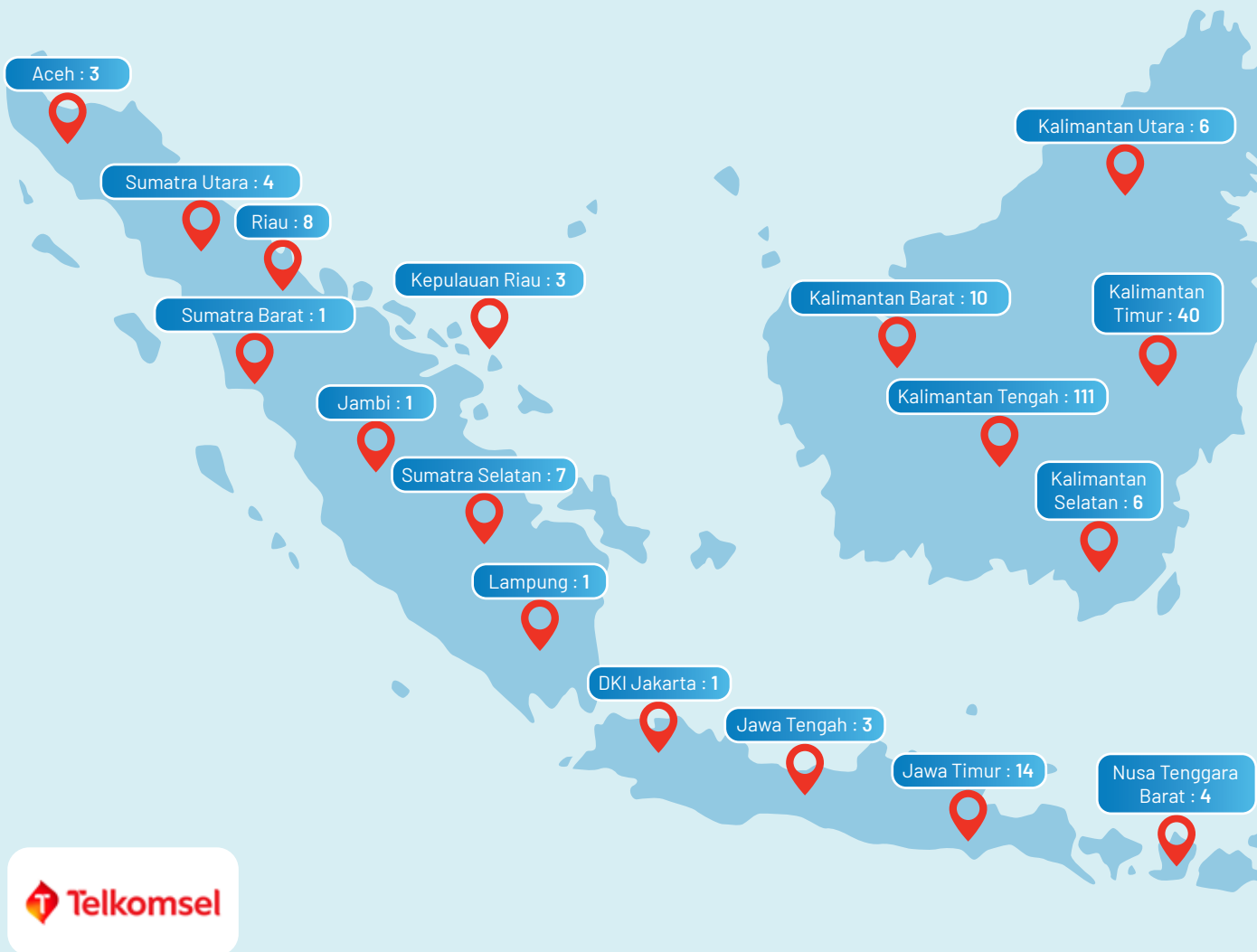
Gambar 37. Penggunaan Pembangkit Listrik Tenaga Surya (PLTS) dan Microhydro (PLTMH) pada BTS di seluruh Indonesia
